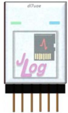
Die rechte LED leuchtet dauerhaft, wenn serielle Daten empfangen werden. Erlischt sie ein paar Sekunden nach dem Start (Power-Up/Reset), werden keine seriellen Daten empfangen. Sobald (wieder) kontinuierlich Daten empfangen werden, kommt es zu einem Dauerleuchten der LED.
