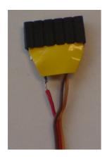
Gut. Dann markieren wir die Oberseite des Kabels (gleich Beschriftungsseite des Loggers) mit einem Stück weißer selbstklebender Folie, wie sie beiliegt, und schrumpfen das ganze Umfeld der Buchse ein. Dabei die Buchse selbst wenigstens teilweise mit einschrumpfen, das gibt den Halt und verhindert Kabelbruch durch Knicken.
