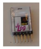
Super! Nun das Label auf der Prozessorseite anbringen (der große "Chip"), "unten" im Sinne der Beschriftung ist an der Seite der Stiftleiste, - gut ausrichten, durch leichtes Andrücken die selbstklebende Folie fixieren.
