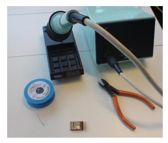
Die Stiftleiste ist mit einer provisorischen Lötstelle "angeklebt" und dabei ausgerichtet worden. Im Hintergrund die "Waffen".
